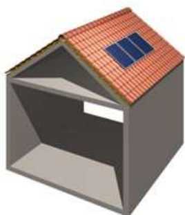
FIGURA 55. VARIANTE DE INTEGRARE A SISTEMELOR FOTOVOLTAICE PE ACOPERIȘURI ÎNCLINATE (Sursa: ECN).
