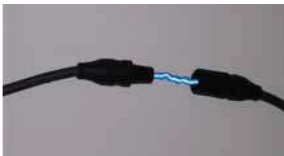
FIGURA 84. PERICOLUL DE ARC ELECTRIC (Sursa: OSEIA,2011)
