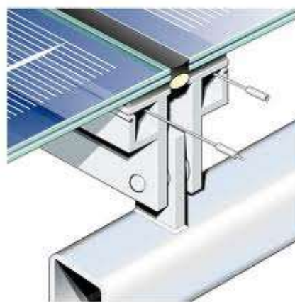
FIGURA 92. UNIREA PANOURILOR FOTOVOLTAICE ( Sursa: Flickr, 2011)
